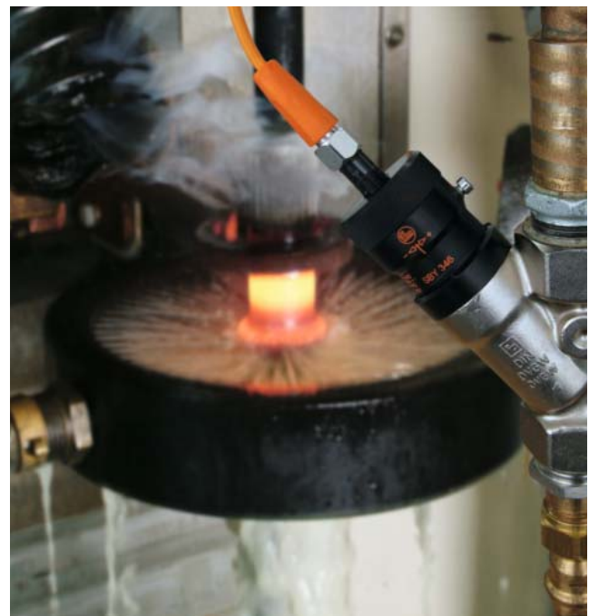
Mechatronischer Sensor im Kühlwasserkreislauf eines Induktionsofens
